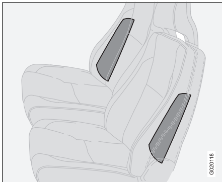
Poziționarea airbagurilor laterale.
